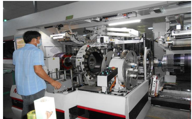
Công đoạn định hình lớp bằng máy tự động (lắp ráp các bộ phận)
