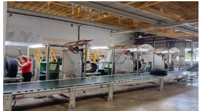
Công đoạn kiểm tra lớp thành phẩm
