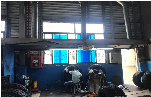
Công đoạn làm sạch, chỉnh sửa lốp xe
