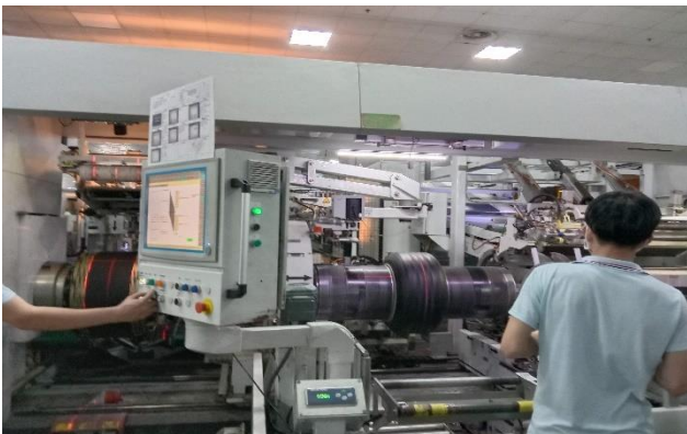
Công đoạn định hình lớp bằng máy tự động (lắp ráp các bộ phận)
